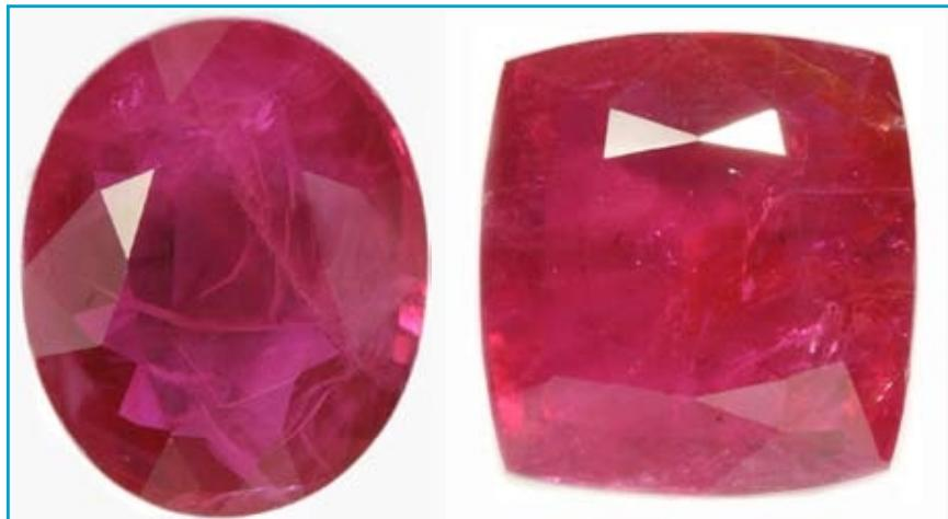
**Рис. 4.** Слева – природный рубин, трещины которого залечены силикатным стеклом, справа – природный рубин, трещины которого залечены свинцовым стеклом
